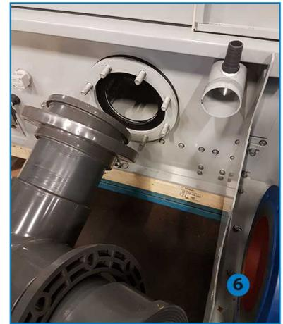
4. Pour pouvoir atteindre les boulons situés sous le support de la pompe, installez l'appareil au moins 10 cm au-dessus du sol.
