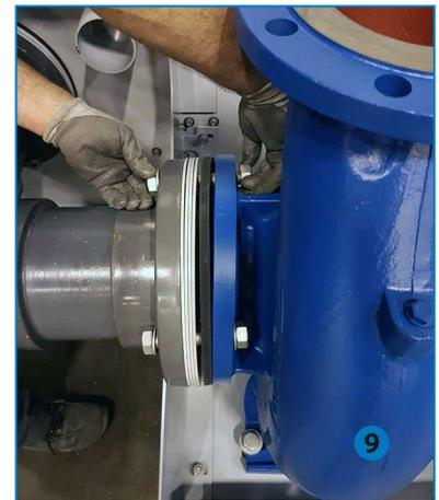
7. Commencez par serrer les écrous des boulons opposés, puis continuez avec les écrous opposés pour distribuer uniformément la force durant l'assemblage des brides.
