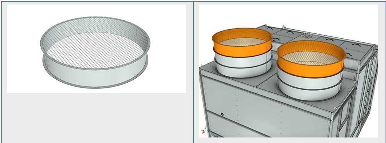
2. Aligner les trous de vissage (utiliser des broches d'assemblage si nécessaire) et serrer boulons et écrous.
