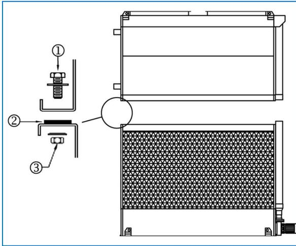
*Installation du joint d'étanchéité*
