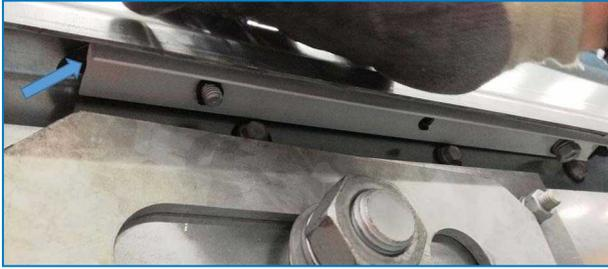
Perfil de sellado instalado
