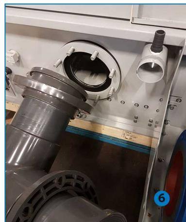
4. Para llegar a los pernos situados debajo del soporte de la bomba, el equipo se debe instalar al menos a 10 cm sobre el nivel del suelo.
