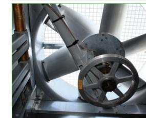
Sistema di trasmissione dei ventilatori facilmente accessibile con linee di lubrificazione estese\*
