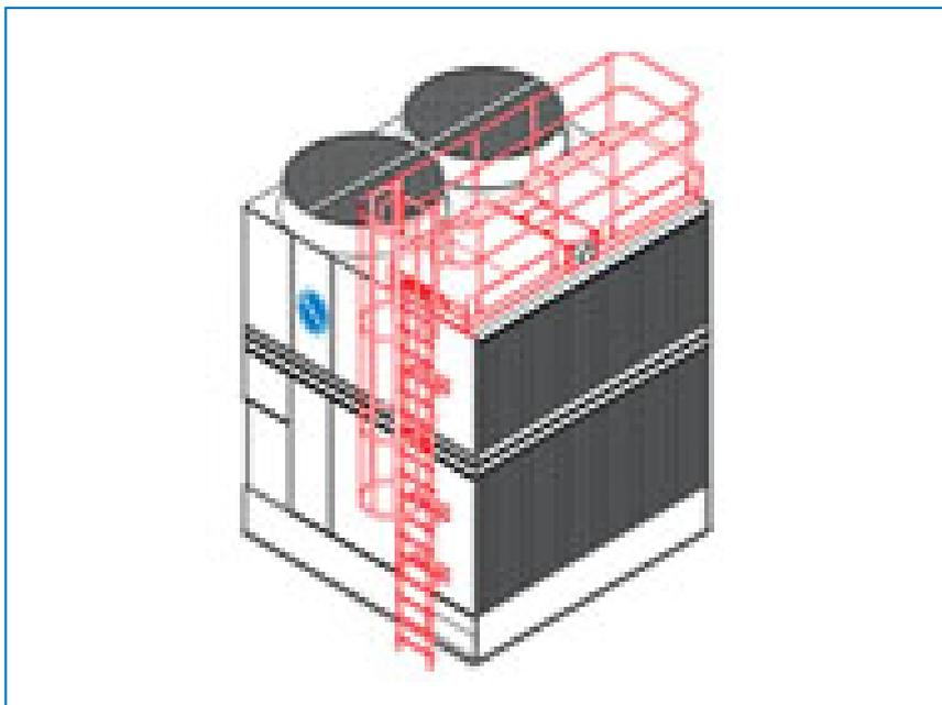
Лестница, защитное ограждение и перила устанавливаются для **легкого доступа к верхней части изделия и его безопасного** осмотра и обслуживания в соответствии с директивами ЕС по безопасности.
