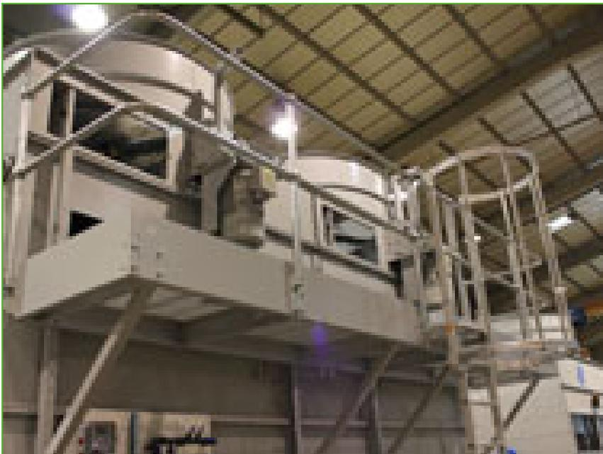
**Plattformen, eine Leiter, ein Sicherheitskorb und Geländer** erleichtern **den einfacheren und sichereren** Zugang des Geräts und machen dadurch Inspektion und Wartung unter Erfüllung europäischer Sicherheitsstandards einfacher.
