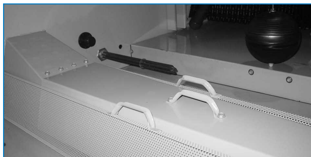
Бассейн холодной воды и сетчатый фильтр бассейна
