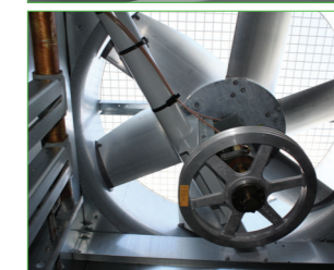
Vlot toegankelijk ventilatoraanrijfsysteem met verlengde smerleidingen*
